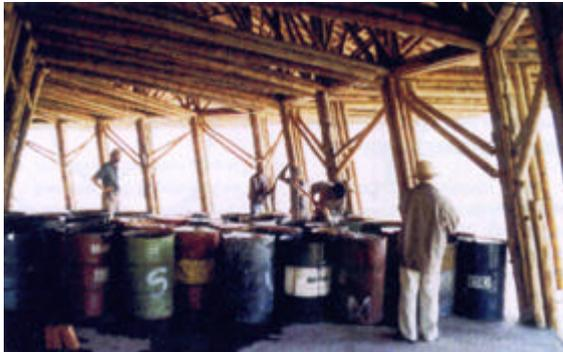
23) "Bild 19. Emporen-Testmasse aus Wasserfässern"
